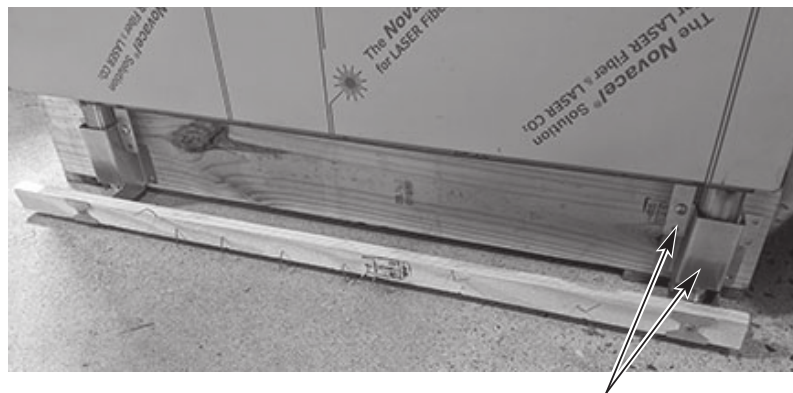
RETIRE LOS SOPORTES DE ENVÍO (4 LUGARES)
