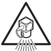
The pressure relief valve must be inspected every six months. / La soupape de décharge doit être inspectée à tous les six mois. / La válvula de descarga de presión debe ser inspeccionada cada seis meses. / Das Druckablassventil muss alle 6 Monate überprüft werden.
