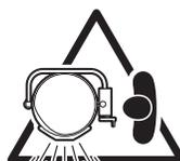
Stand clear of product discharge path when discharging hot product. / Se tenir loin du chemin de purge des produits lors de la purge des produits chauds. / Manténgase alejado de la trayectoria de descarga del producto al descargar producto caliente. / Nicht im Produktauslasspfad stehen während das heiße Produkt entleert wird.
